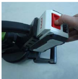
Rimozione della batteria
